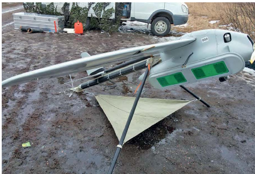
Малогабаритная антенна с синтезированной апертурой на базе беспилотного летательного аппарата «Птеро-СМ»
