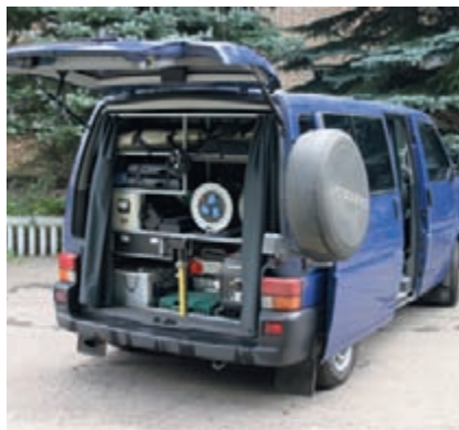
Подвижный лабораторный комплекс по выявлению источников непреднамеренных помех РЭС ВВС, мониторинга радиоэлектронной обстановки и проведения натурных экспериментальных исследований
