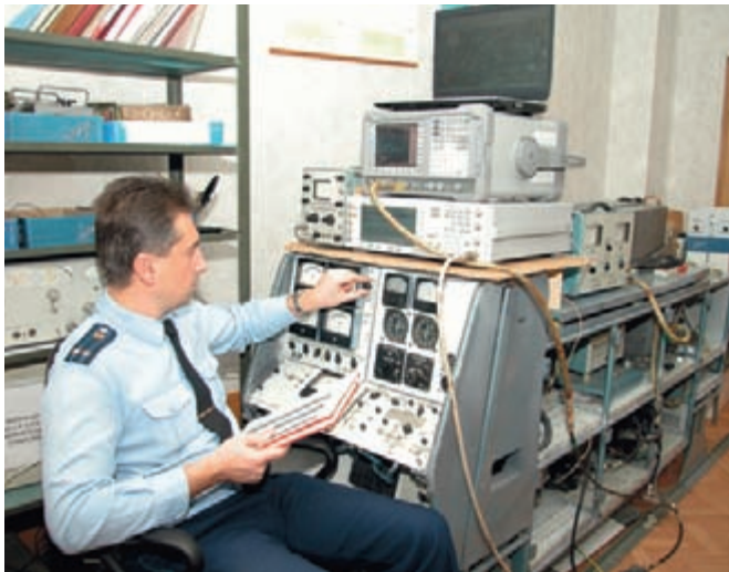
Лабораторный комплекс по исследованию помехозащищенности бортового оборудования РСБН к непреднамеренным помехам, создаваемым РЭС различных стандартов (GSM, UMTS, LTE, DVB-T2 и др.)
